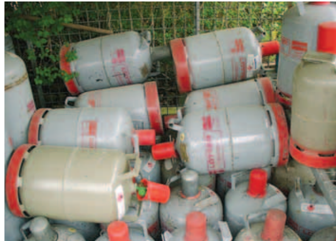
So nicht: Gasflaschen müssen stehend gelagert werden!
