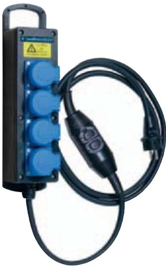
selbstschließenden Klappdeckeln gemäß DIN/VDE 0620-1 und eine Gesamtschutzart von IP54 machen die Walther-Steckdosenleiste mit 3-poligem PRCD-S (16/0,03 A) geeignet für raue Bedingungen an häufig wechselnden Einsatzorten – bei Bau- und Montagearbeiten, im Katastrophenschutz und überall sonst, wo ortsveränderliche Elektrogeräte gewerblich genutzt werden. Eine große Öse zum Aufhängen und Bohrungen zur Wandbefestigung erleichtern die Handhabung.
