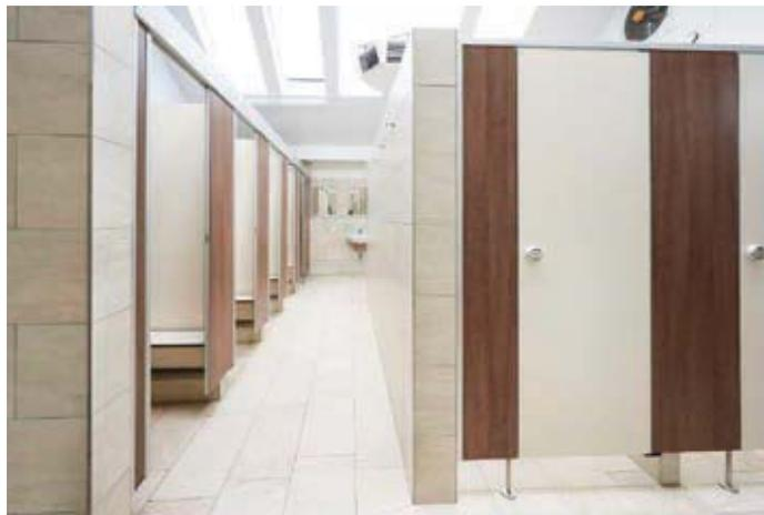
Extrem belastbar ist das Trennwandsystem EF-3 mit bauseitig gemauerten Sockeln und eloxierten Stützfüßen.
